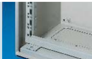
Kabelflanschplatte aus 1,5 mm Stahlblech unten im Gehäuse positioniert und herausnehmbar, austauschbar gegen Kunststoff-Flanschplatte SZ 2563.000.
